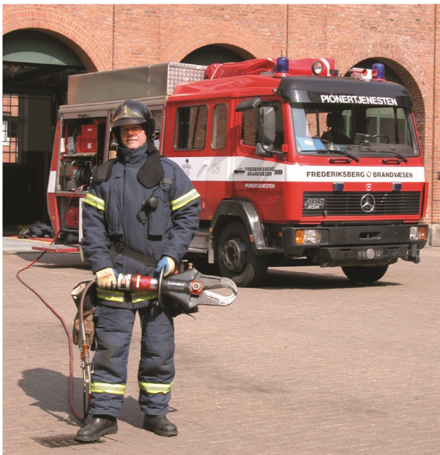
Geräte können mittels Schlauchverbindung in einer Entfernung von bis zu 40 Metern vom Rettungsfahrzeug eingesetzt werden.
