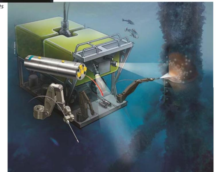
Système de nettoyage par projection d'eau à haute pression sur un engin télécommandé
