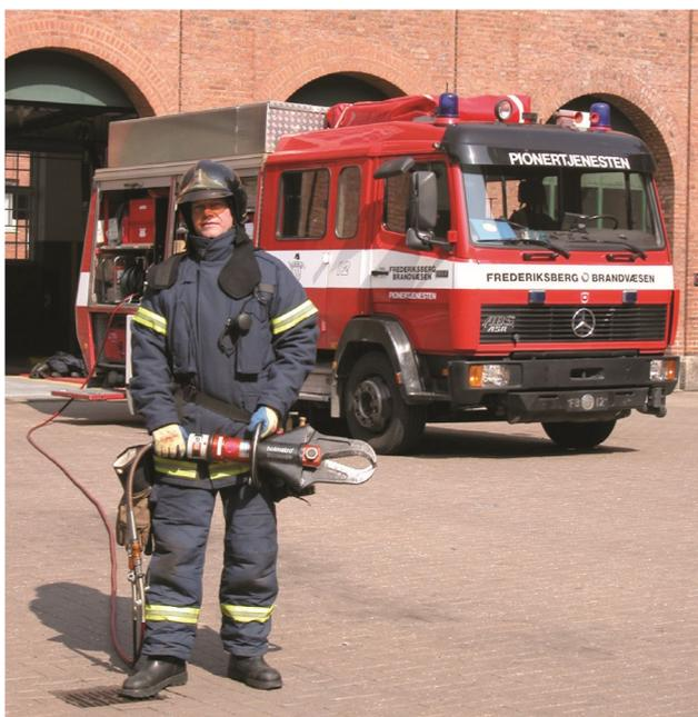
Gli strumenti possono essere utilizzati a una distanza di 40 metri dal mezzo di soccorso con l'aiuto di tubi.
