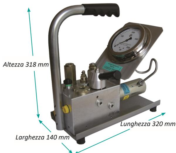
Utilizzando il sistema di intensificazione M-HC7 è possibile utilizzare tubi a bassa pressione e incrementare la pressione appena prima dello strumento.
