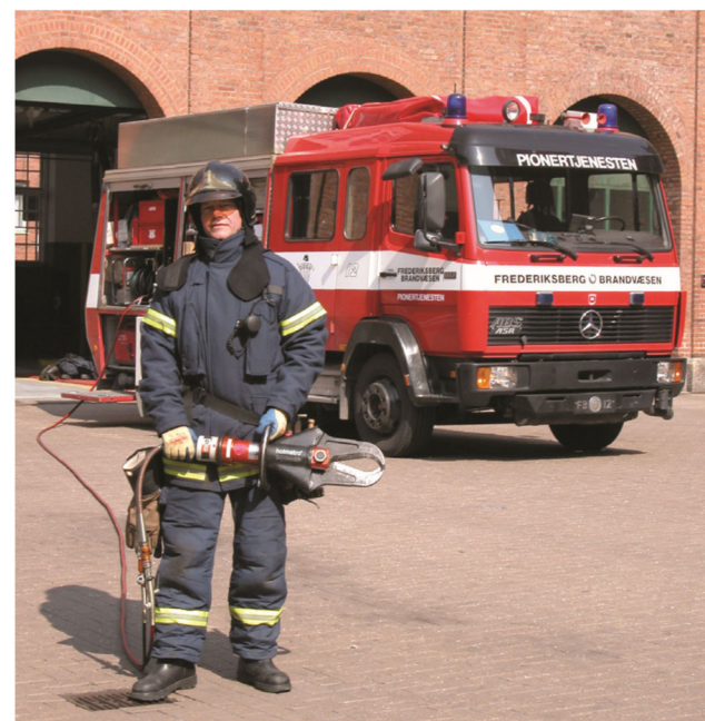
При использовании шлангов работа с инструментами возможна на расстоянии 40 метров от спасательного грузовика.
