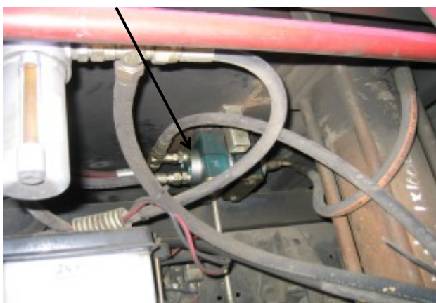
Intensificatore HC4 collocato sotto il corpo del camion
