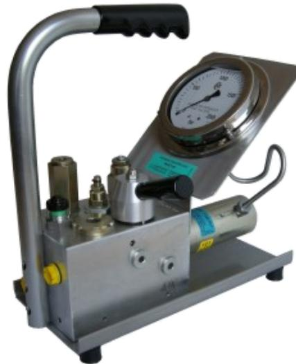
大型クレーンの製造および安全メンテナンスの実施にあたり、数本の大型ボルトを伸縮させます。高品質な組立および優れた均質性のため、油圧ボルトテンショナーを使用することが多くなります。miniBOOSTERで160バールから、大型ボルトの伸縮に必要な最大1500バールに増圧し、クレーンの油圧系統にタッピングすると、テンショナーを迅速かつ容易に作動させることができます。空気駆動式パワーパックと比較して、本ソリューションは最大で5倍速くなります。
