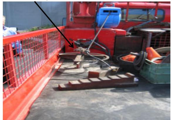
Усилитель HC4, размещаемый под кузовом грузовика
