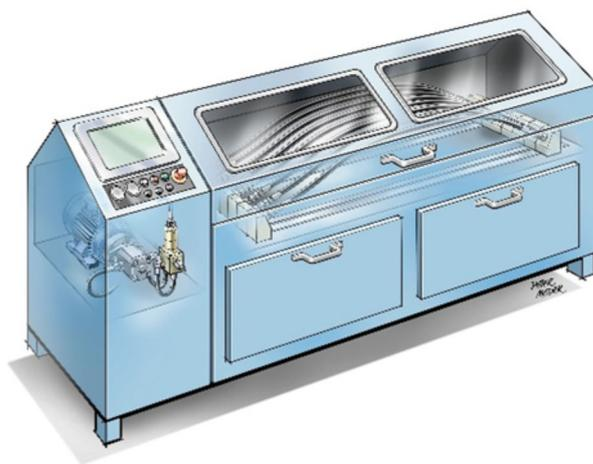
Управление высоким давлением с точностью до 1% путем включения и выключения miniBOOSTER по сигналу обратной связи от датчика давления.
